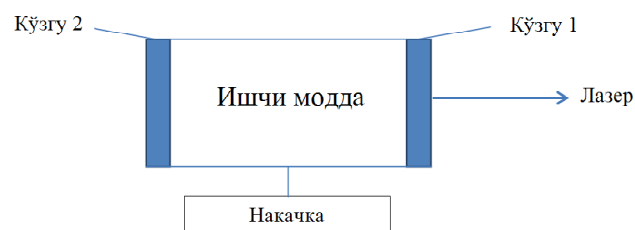
6-расм. Лазер қурилмаларининг функционал схемаси.
