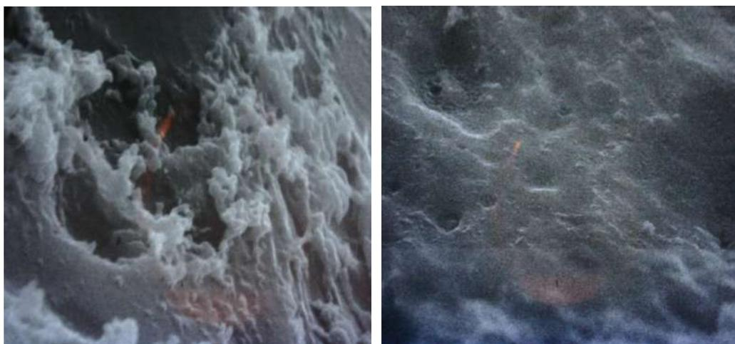
**Рис. №3а - ЧСП и №36 ПСП изготовленной из «Фторакс» после обработки адгезив. СЭМ x 400**
